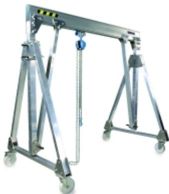
Portique en aluminium roulant 2000 kg/4 m - XL. Ce portique de levage mobile monopoutre est réglable en hauteur et en portée. Léger et de faible encombrement, il se transporte et se met en œuvre facilement à l'aide d'une clé à molette taille 24 et une clé BTR taille 11. Portique déplaçable en charge, il peut être utilisé en intérieur ou en extérieur pour des travaux de pose, dépose ou positionnement de charges.
