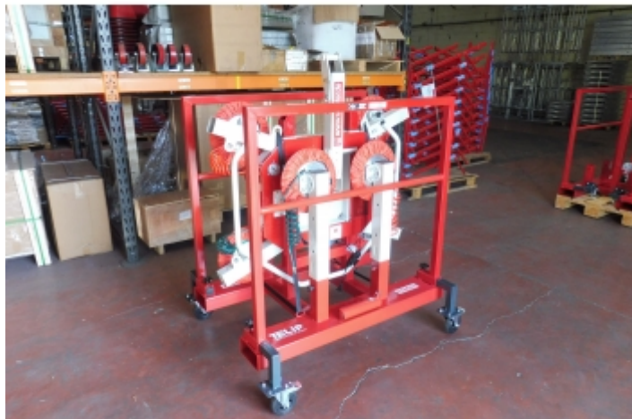
Chariot de transport pour palonnier à ventouses upg
