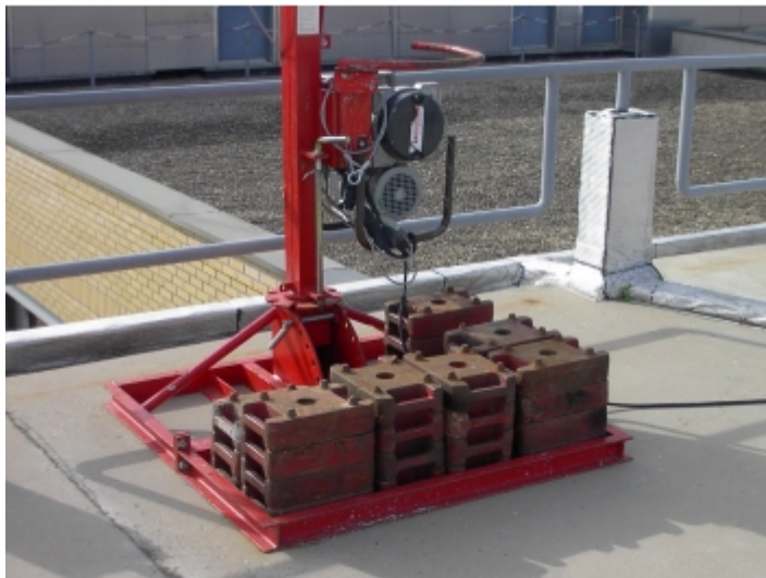
Lestage d'une grue gs250
