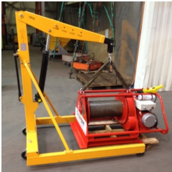
Déplacement d'un treuil au sol en atelier
