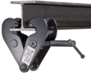
Griffe sur profilé 3000 kg. Ce matériel est idéal pour créer rapidement un point d'ancrage pour les matériels de levage comme un palan à chaîne (électrique, manuel ou pneumatique) ou une poulie. Le réglage s'effectue automatiquement dès le serrage de la vis principale. Elle peut être montée sur tous types de profilés (IPN, IPE, HEA, HEB).
